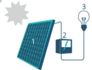
1. Zonnepaneel | 2. Omvormer | 3. Elektrische toestellen
